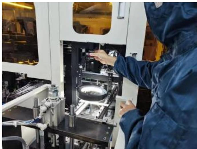
图 20 师生团队调试研发的机器视觉检测设备
